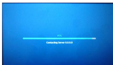
3.- Para configurar el TFTP es necesario presionar **“tecla de opciones”** (resaltada en amarillo en la imagen) cuando el teléfono este en 95% de su configuración.
